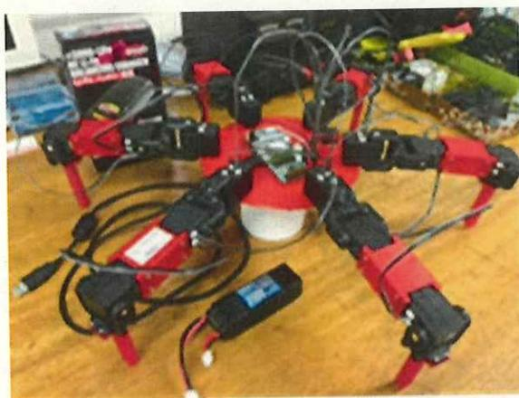
ナビゲーション実験に供するため6脚移動ロボットを設計・製作した。
